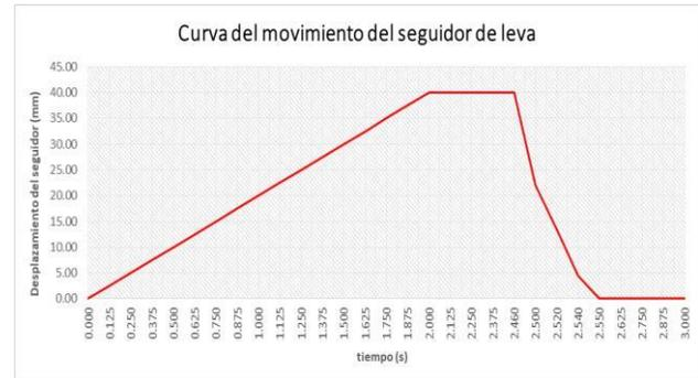
**Figura 2.** Curva del movimiento del seguidor de leva
